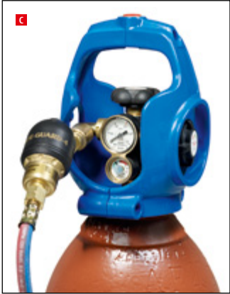
Bilde C Monter tilbakeslagssikring for acetylen og oksygen.
